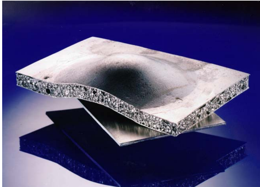
Abb. 14: Aluminiumschaum-Sandwichmaterial (vor und nach dem Schäumen)
